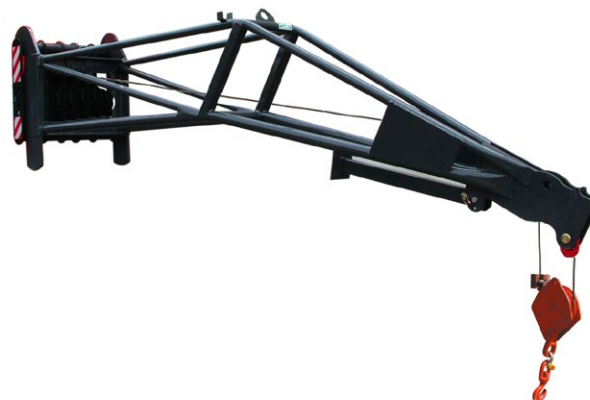
PROLUNGA A TRALICCIO CON VERRICELLO L=2,5 M - P=1,2 T O 4 M - P=0,6 T (FOTO) HOIST WITH WINCH L=2,5 M - P=1,2 T OR 4 M - P=0,6 T (PHOTO)
